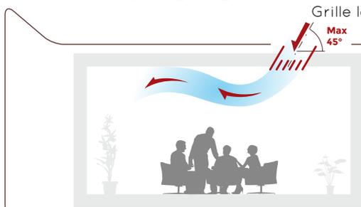
**Effet Coanda :** effet généré par les lames courbes de la grille de soufflage qui entraînent une accélération du flux d'air vers le plafond afin d'éviter un contact direct avec les occupants.
