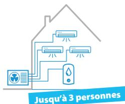
Une solution unique couvrant les besoins en chauffage, rafraîchissement et ECS au sein d'un même système.
