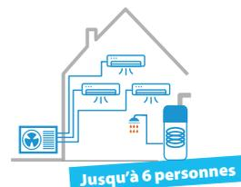
2 systèmes distincts couvrant d'une part la production de chauffage et le rafraîchissement par le biais de la solution Multisplit, et l'Eau Chaude Sanitaire par le chauffe-eau thermodynamique.
