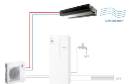
ATTENTION : chaque mode de fonctionnement présenté ci-dessus doit être utilisé individuellement. Il n'est pas possible de faire fonctionner la solution Ecodan Smart dans deux modes différents en simultané.
