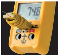
Thermocouple de type K pouvant être branché directement sur le multimètre (SC240/SC260)
