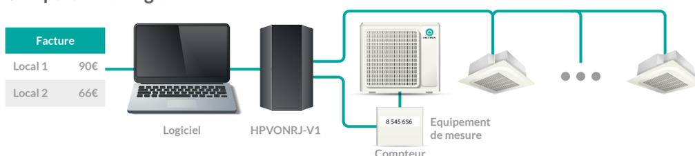
Le compteur d'énergie peut être utilisé comme un outil de facturation intelligent. Sa méthode de calcul ajustée permet une refacturation équitable.
