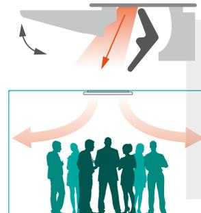
Mode chauffage : flux d'air vertical en mode chauffage pour une répartition efficace et rapide de l'air chaud.
