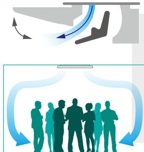
Mode refroidissement : flux d'air oscillant à grand angle et horizontal afin d'éviter la sensation de souffle.
