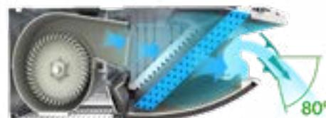
L'angle de balayage du volet inférieur s'ouvre jusqu'à 80° pour couvrir un large espace devant le plafonnier.
