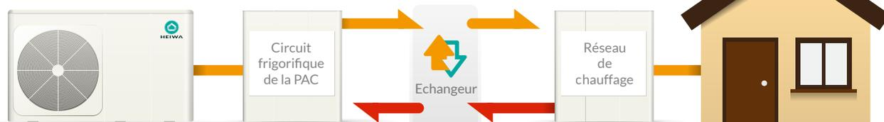
En mode chaud, la PAC Air/Eau va capter les calories dans l'air extérieur et les échanger avec l'intérieur au travers d'une boucle d'eau via un plancher chauffant, des radiateurs et/ou des ventilo-convecteurs. Ce transfert de calories entre l'extérieur et l'intérieur s'opère au travers d'un échangeur à plaques.
