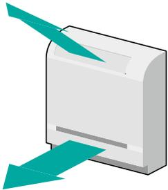
La fonction double flux permet d'homogénéiser la température d'une pièce grâce à la diffusion d'air en en partie haute et en partie basse.
