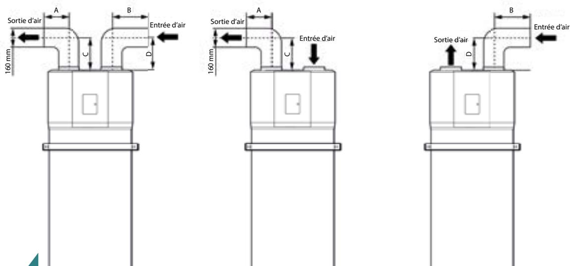
Utilisation d'un réseau de gaine rigide PEHD jusqu'à 10 mètres.
