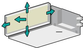
Le filtre peut être démonté selon 5 directions. L'installation et la maintenance sont plus simples et plus rapides quel que soit le lieu d'installation.
