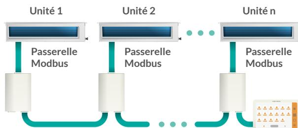
Cette commande est nativement compatible avec la gamme Heiwa DRV. Il est alors possible de piloter une installation complète mixant ces 2 technologies en isolant, par exemple la salle serveur informatique du reste de l'installation.
