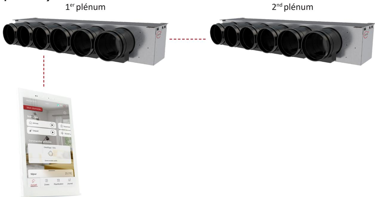
Si l'installation est constituée de 2 plénums pilotés par une seule tablette, il faut relier les 2 plénums grâce aux connecteurs roses fournis. Créer le câble ci-après en utilisant les connecteurs et un câble LIYCY 2 x 0,5 mm<sup>2</sup> blindé.
