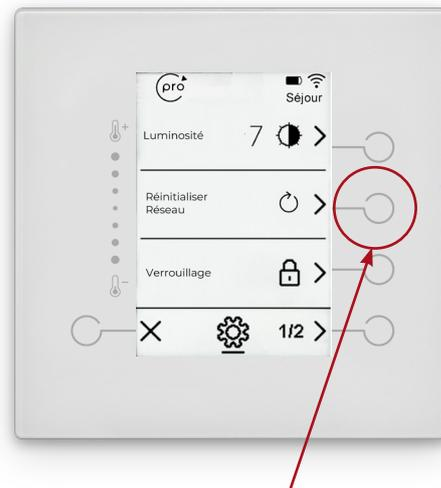
Sélectionner « Réinitialiser le réseau » pour mettre le thermostat en appairage.
