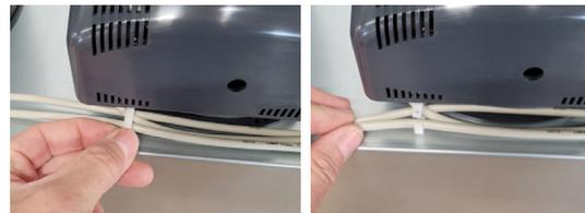
**3** Déclipser le registre motorisé, le faire tourner de 180° dans le sens anti-horaire et le repositionner.
