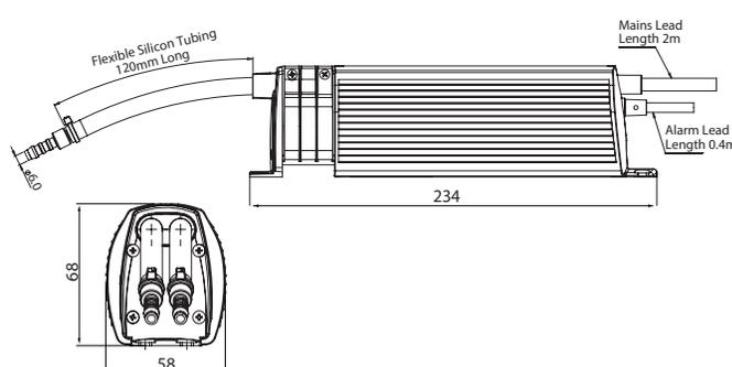
La MegaBlue peut être installée dans toutes les directions jusqu'à 7 mètres de distance de l'unité de climatisation.
