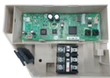
Les interfaces additionnelles PAC-SJ95MA-E, se raccordent directement sur les groupes extérieurs MR SLIM. Elles permettent de créer un réseau M-NET (Mitsubishi Electric Network). Il sera possible de piloter les installations MR SLIM depuis des télécommandes adressables, commandes centralisées ou encore des passerelles de communications (BACNET, LONWORKS, MODBUS).
