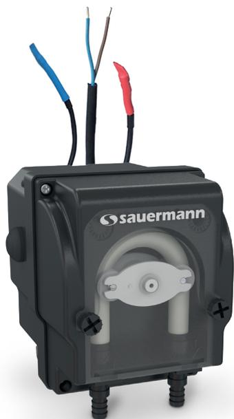
Cette pompe péristaltique est conçue pour tout type de climatiseur jusqu'à 8 kW de puissance : unité murale, armoire de climatisation, allège, plafonnier et gainable. Équipée de deux sondes de température déportées, la Si-51 s'active lorsque le différentiel de température de l'air entrant et sortant du climatiseur dépasse les 6 °C. La pompe fonctionne encore pendant 4 minutes lorsque l'écart de température repasse sous les 6 °C.
