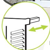
Profondeur ajustable de 150mm
