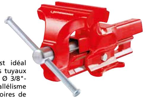
L'étau parallèle est idéal pour le serrage des tuyaux de tous types avec Ø 3/8"-2" En raison du parallélisme constant des mâchoires de serrage, les tuyaux affleurent, ce qui entraîne une résistance au glissement et une répartition équilibrée de la pression de serrage.
