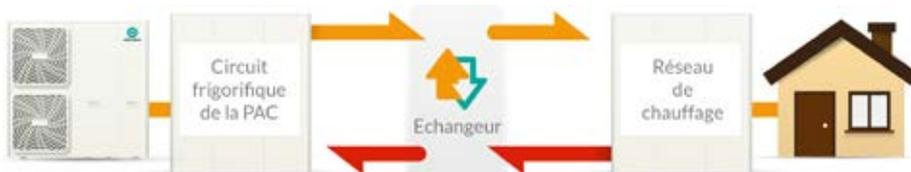
En mode chaud, la PAC Air/Eau va capter les calories dans l'air extérieur et les échanger avec l'intérieur au travers d'une boucle d'eau via un plancher chauffant des radiateurs et/ou ventilo-convecteurs.
