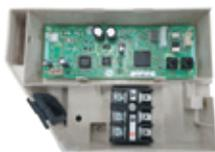
Les interfaces additionnelles PAC-SJ95MA-E / PAC-SJ96MA-E, se raccordent directement sur les groupes extérieur MR SLIM. Elles permettent de créer un réseau M-NET (Mitsubishi Network). Il sera possible de piloter les installations MR SLIM depuis des télécommandes adressables, commandes centralisées ou encore des passerelles de communications (BACNET, LONWORKS, MODBUS).
